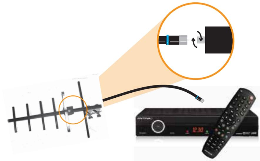
**IMPORTANTE:** Las conexiones deben hacerse a rosca como se indica en el gráfico. Asegurate que los conectores estén bien ajustados. Si te sobra cable, no te compliques cortándolo, solamente enrollalo.
