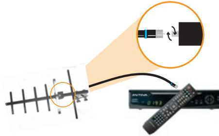
Las conexiones deben hacerse a rosca como indican los gráficos. Asegúrate que los conectores queden bien ajustados. Si sobra cable no lo cortes, enróllalo. No dobles ni quiebres el cable en ninguna parte de su recorrido dado que puede provocar deterioro en la imagen.
